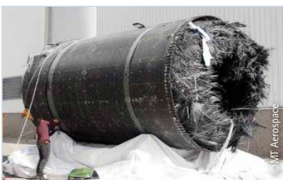
Demonstratorgehäuse nach erfolgreichem Struktur- und Bersttest
